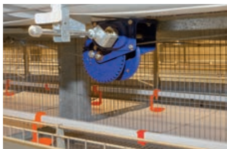
Центрально смонтированная лебедка для регулирования высоты линии поения
