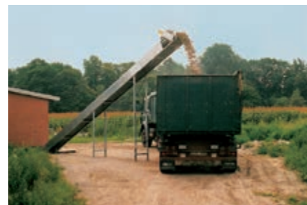
Поступление помета напрямую в грузовик
