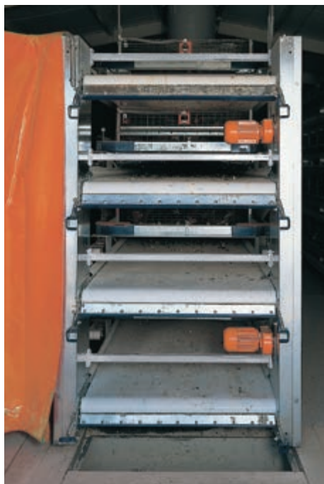
Конечный узел пометоудаления с пометоприемной шахтой
