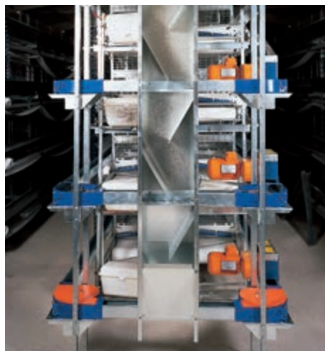
Кормовая колонка в форме каскада предотвращает склеивание корма
